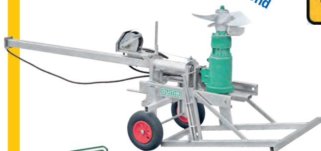
Mobile Tauchmotorrührwerke Für geschlossene Güllebehälter bis 3.5 m tief Motor Leistung 7.5 kW + 9 kW Spezieller Rührflügel Fahrwerk schmal / breit
